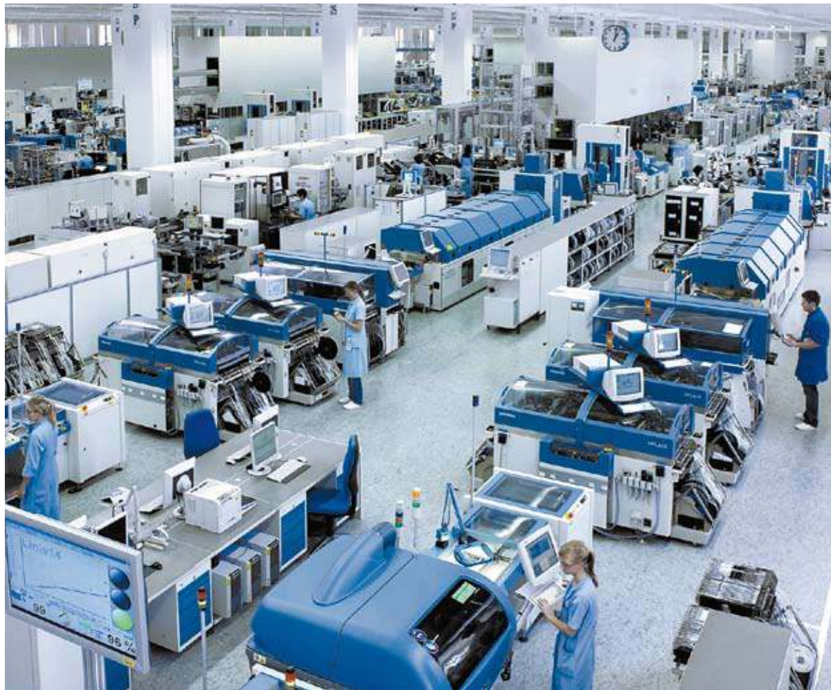
Das Elektronikwerk von Siemens in Amberg ist eine der modernsten Fabriken der Welt. Hier stecken Funkchips in den Werkzeugträgern und speichern Informationen wie Teilelisten und Montageanweisungen. Hierfür ist das Werk in der Oberpfalz mit mehreren Preisen ausgezeichnet worden.
